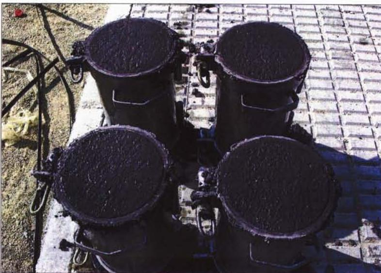
Probetas cilíndricas con las que se comprueba la resistencia del hormigón. L. O.
